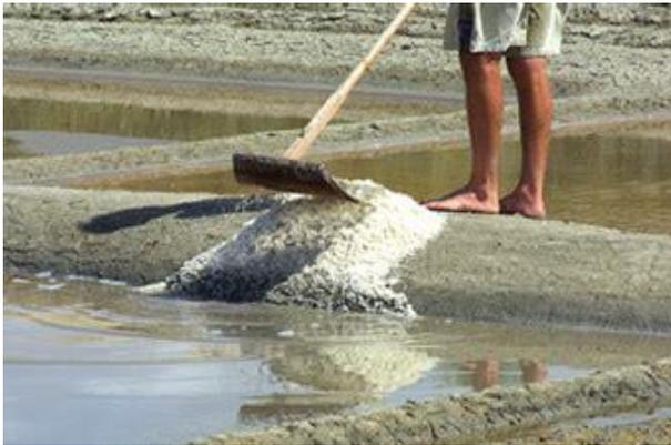
Le paludier tire le sel sur le bord des bassins grâce au souvron. Les trous dans la planche du souvron permettent à l'eau de passer. Ensuite, le paludier se sert du dos de l'outil pour former des petites pyramides de sel.
