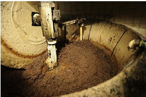
Les olives sont placées dans la cuve et broyées par la meule. On trouve le même système pour fabriquer l'huile de noix.
